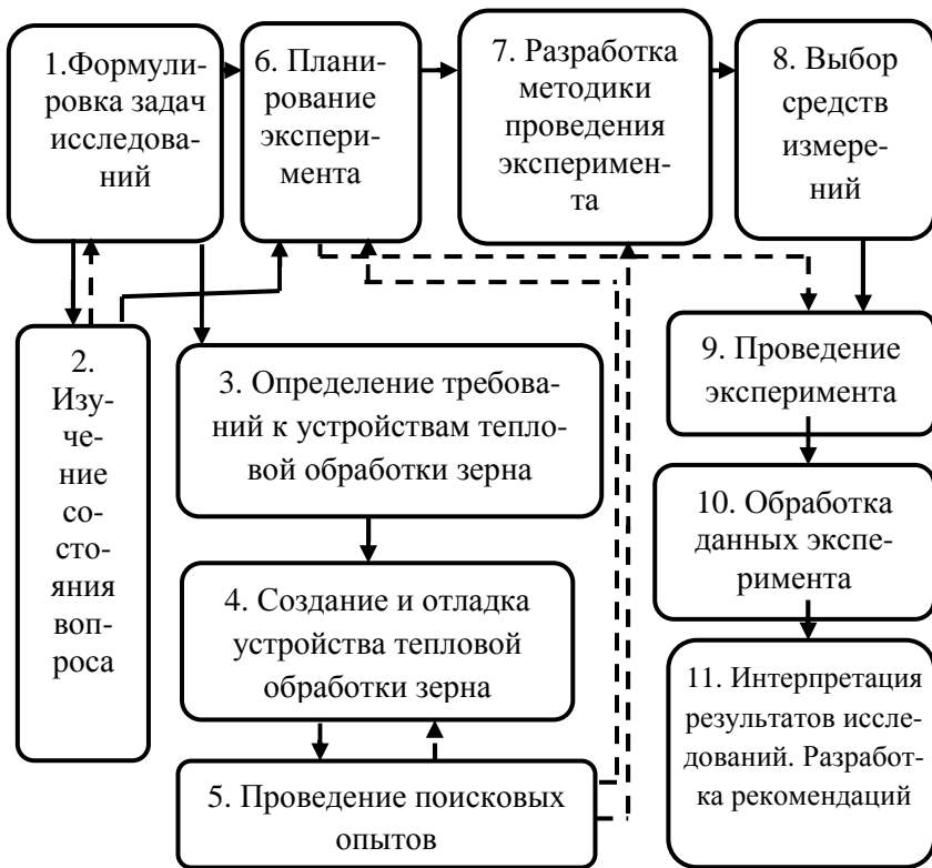
Рисунок 3 – Блок-схема алгоритма экспериментальных исследований процесса тепловой обработки зерна
